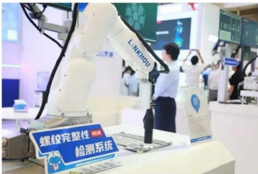
图9灵猴螺纹完整性检测系统
