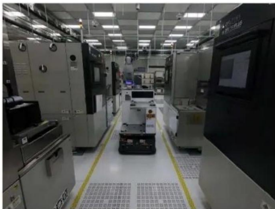
图12 捷螺智能AMR 自主移动机器人用于半导体封装智慧制造产线
