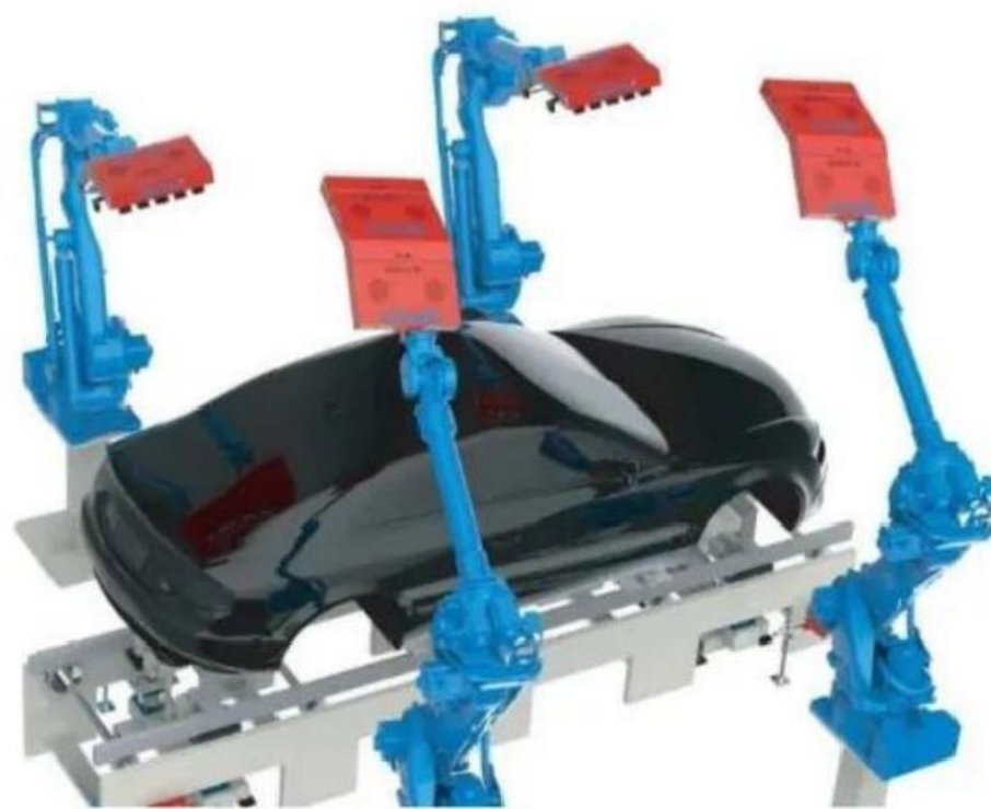
图6斯睿特漆面外观检测智能工作站
